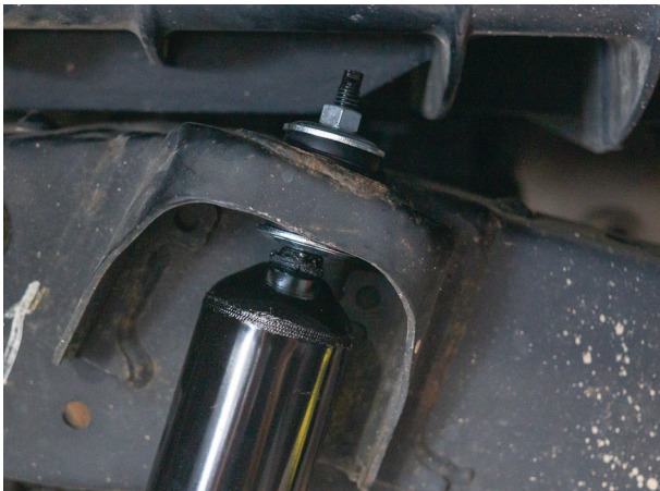
Fig. 19: Remove stem top nut.
